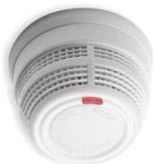
Il rivelatore ottico di fumo e calore associa due principi di rivelazione distinti: la rivelazione di fumo, adatta per la rivelazione di incendi a lenta progressione dove possono trascorrere anche diverse ore prima che l'ambiente vada a fuoco, e la rivelazione del gradiente termico, in caso di incendi a rapida o media progressione.
