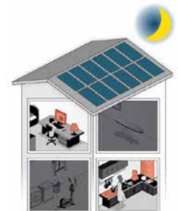
Notte: Carichi importanti vengono alimentati dalla batteria
