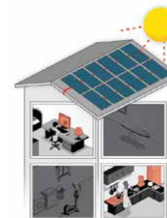
Giorno: Carichi importanti vengono alimentati dapprima dal sistema FV e poi dalla batteria. La batteria può essere caricata da FV se necessario
