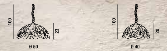
T964 S Sospensione Tiffany con catena Tiffany hanging lamp with chain 3XE27 ◀ MAX 60W H. REGOLABILE T962 S Sospensione Tiffany con catena Tiffany hanging lamp with chain 1XE27 ◀ MAX 60W H. REGOLABILE T964 Solo paralume Tiffany Tiffany lampshade only T962 Solo paralume Tiffany Tiffany lampshade only
